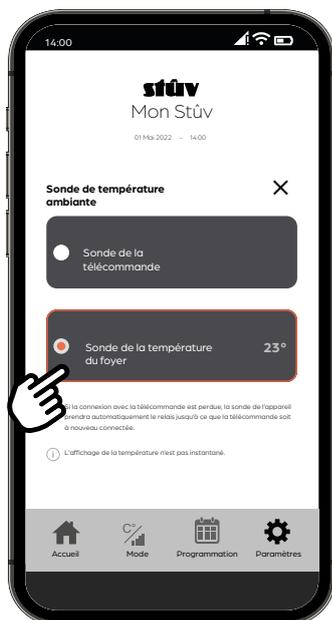
La sélection "sonde de température ambiante" permet de sélectionner l'origine de la mesure de la température: soit la sonde intégrée à la télécommande, soit celle intégrée au foyer.
