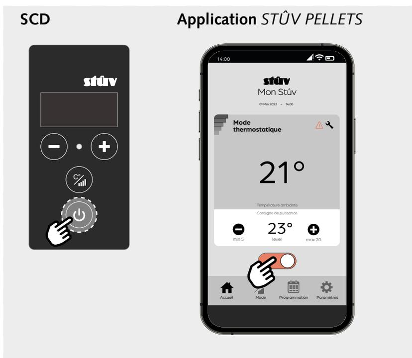
Une fois le cycle d'extinction initié, l'apport en granulés du réservoir est interrompu et la seconde vis de chargement se vide complètement. Le Stûv P10.3 continue donc à fonctionner pendant approximativement 15 minutes à une puissance équivalente à P10.
