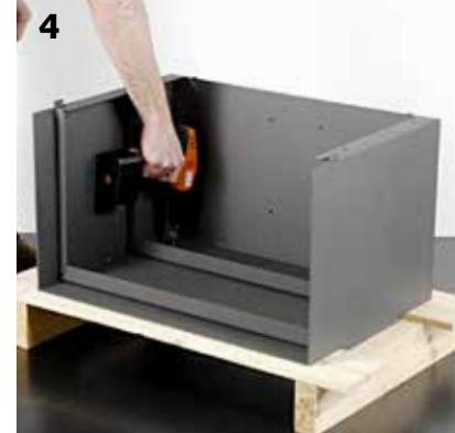
Posizionare una protezione sul pavimento e capovolgere la base sul suo lato posteriore per avvitare saldamente i 4 piedi regolabili.
