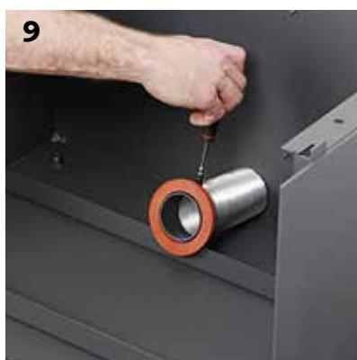
In het geval van een luchttoevoer via de achterkant, gebruikt u de stop die uit de houtsokkel in punt [6] gesneden is en brengt u die aan op de uitsnijding in de bodem van de houtsokkel (tussen het kanaal en de houtsokkel). Deze stop dient dan als verbindingsstuk [foto 10].
