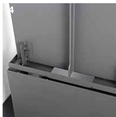
Riavvitare l'asse di rotazione e fissare i piedi con le 2 viti M5x12 a testa esagonale.
