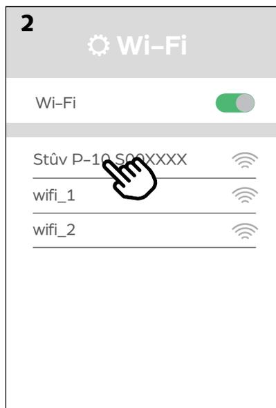
> Premere a lungo (min. 6 secondi) sul pulsante [diagramma 1], il led dopo aver premuto il pulsante dovrebbe lampeggiare di colore arancione. Ciò indica che la stufa a pellet Stûv P-10 è in modalità "access point" ed è pronta per essere collegata ad una rete WiFi [figura 1].
