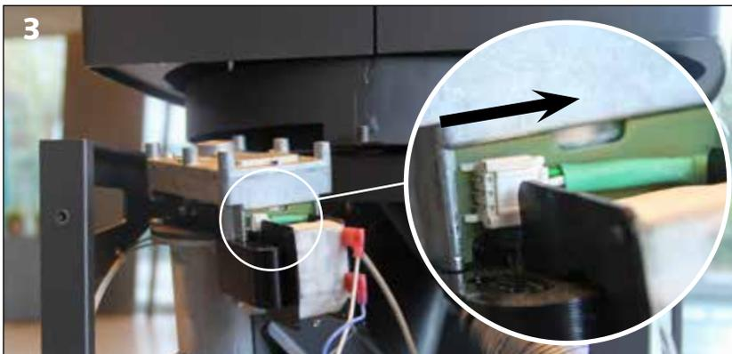
Trennen des Sensors an der langen Schraube
