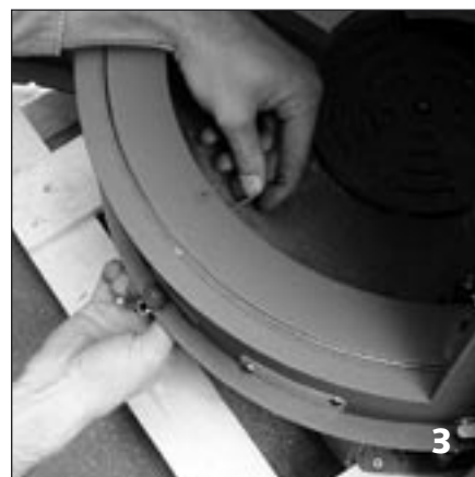
3 À l'aide de la clé à douille de 8, dévisser la vis qui maintient la commande du registre.
