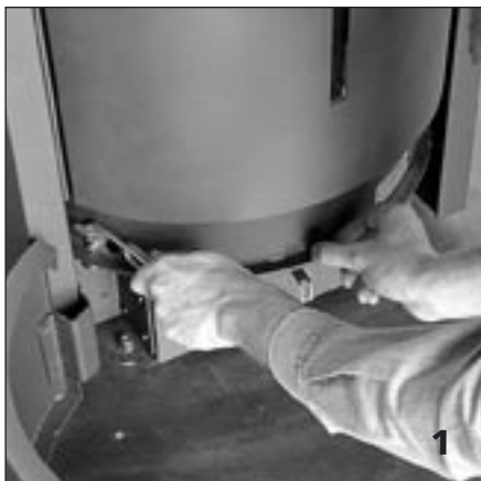
1 Tourner le tambour pour accéder facilement au roulement.
