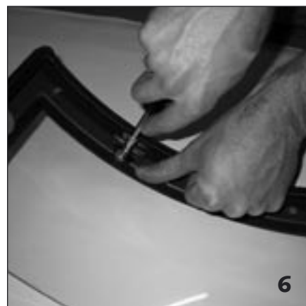
6 Revisser les serre-vitre en poussant sur la vitre pour ne pas abîmer l'arête de la vitre. Attention , placer le côté sans bavures face à la vitre.
