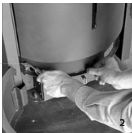
2 Tourner le tambour pour accéder facilement au roulement (ou au crochet de préhension).
