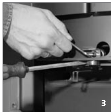
3 Placer un tournevis plat entre le rail et l'anneau inférieur du tambour pour le surélever légèrement. À l'aide de la clé Allen n°4, débloquer la vis (2 ou 3 tours) et déplacer le crochet de préhension vers la droite pour extraire le roulement par l'orifice prévu.
