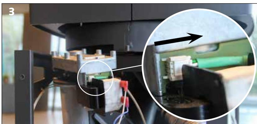
Déconnexion du capteur au niveau de la vis longue.
