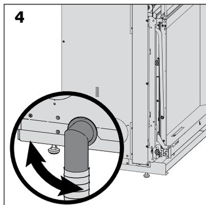
Un Stûv microméga équipé d'un habillage prêt-à-poser ne peut être relié à l'arrivée d'air extérieur qu'au travers du raccord spécifique [schéma 3 & 4].
