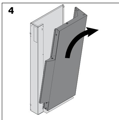
Il faut désolidariser les parements des structures corps afin de les placer indépendamment sur le foyer [schéma 4].
